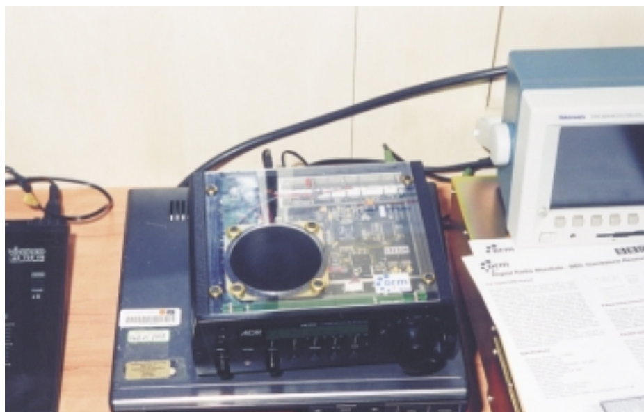
Ein Blick von oben in den AOR AR-7030. Die zusätzliche DRM-Platine ist gut sichtbar
